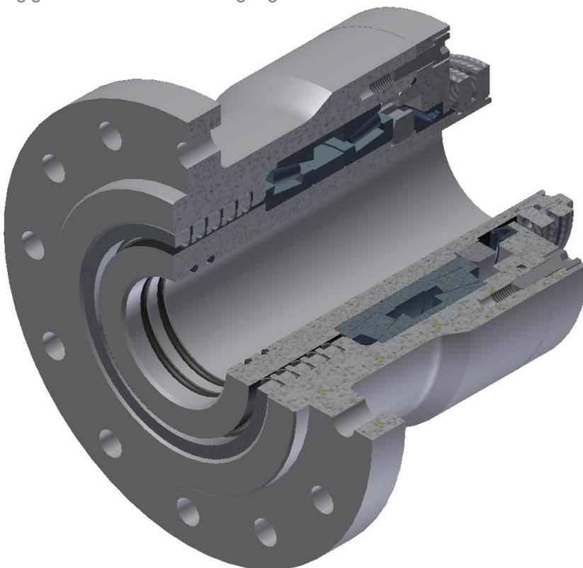
Grundsätzlich werden die Kegelrollenlagereinheiten in „O“ – Anordnung eingesetzt. Durch diese „O“ – Anordnung erreicht man einen großen wirksamen Lagerabstand und somit eine hohe Steifigkeit der Welle innerhalb der Dichtung.
